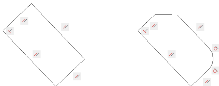
図 27. 推測拘束を使用したフィレットと面取り
