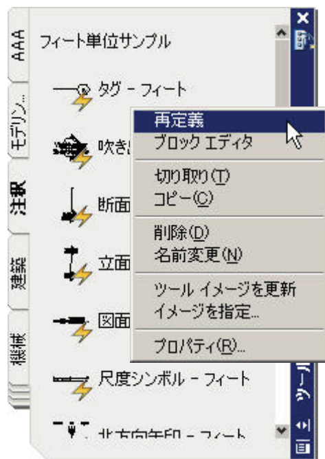
図 10. ツール パレットのブロック定義を図面内のブロックで再定義
